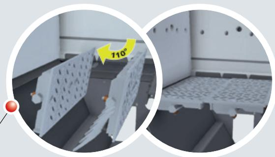
Grille de combustion en plusieurs parties constituée d'une zone fixe de rallonge et d'une grille basculante automatique en deux parties
