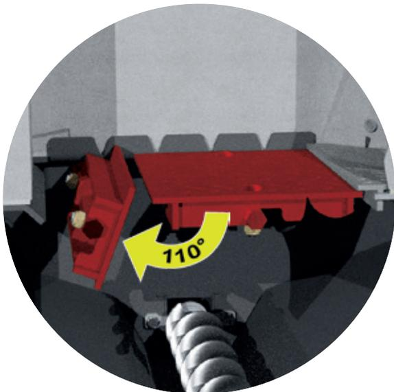
Zweiteiliger Verbrennungsrost bestehend aus einer festen Aufschubzone und automatischem Kipprost garantieren einen energiesparenden Betrieb und geringste Emissionen.
