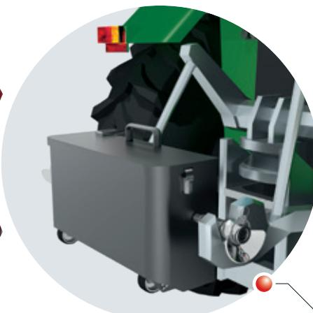
Praktische Hydraulik-Vorrichtung zum Transport mit dem Traktor und einfacher Entleerung (Kippen)
