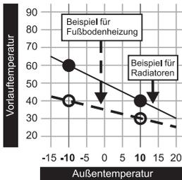
Über die Heizkurve des Heizkreises wird in Abhängigkeit der Außentemperatur mit den zwei einstellbaren Parametern „Vorlauftemperatur bei  $-10^{\circ}\text{C}$  Außentemperatur“ und „Vorlauftemperatur bei  $+10^{\circ}\text{C}$  Außentemperatur“ eine Vorlauftemperatur errechnet.
