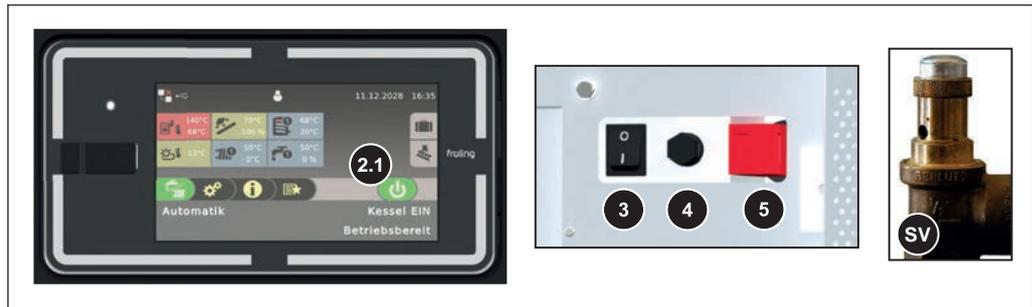
**2.1 KESSEL AUS** (*Ausschalten des Kessels bei Überhitzung*)
