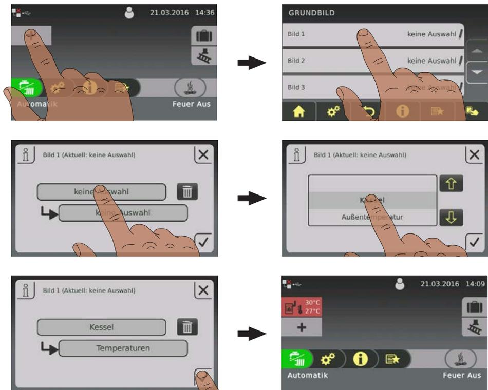
Bei Verwendung von mehr als zwei Pufferfühlern ist eine Informationsanzeige mit Puffertemperaturen gemäß der Anzahl an Fühlern möglich. Die Darstellung erfolgt in einer über zwei Flächen verlaufenden Informationsanzeige.
