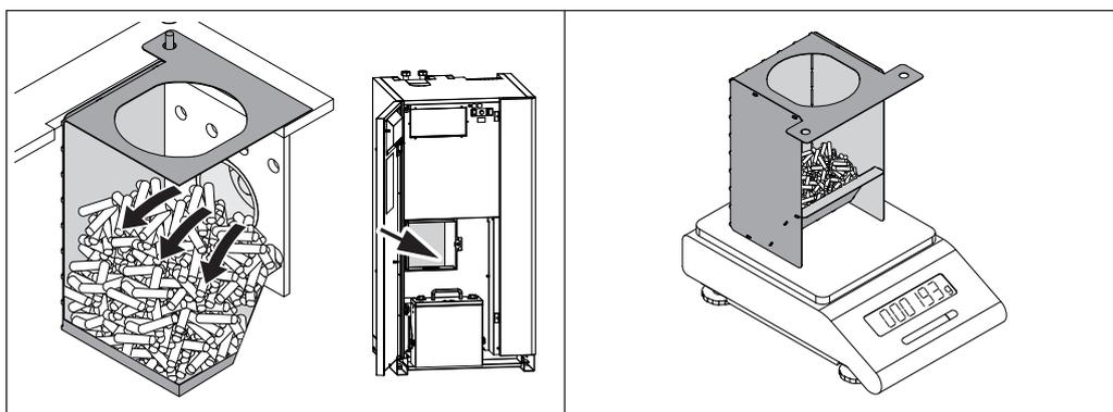
Ist der Vorgang beendet, alle Pellets von der Einschuböffnung per Hand in den Auffangbehälter befördern, sodass beim Entnehmen keine Pellets in den darunterliegenden Ascheraum fallen
