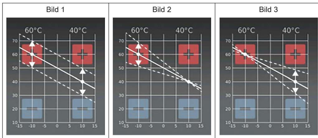
Die Heizkurve kann je nach Situation durch Tippen auf „+“ oder „-“ bei +/-10°C Außentemperatur angepasst werden.
