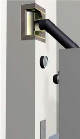
Gemäß EN 303-5 ist die gesamte Abgasanlage so auszuführen, dass möglichen Versottungen, ungenügendem Förderdruck und Kondensation vorgebeugt wird. In diesem Zusammenhang weisen wir darauf hin, dass im zulässigen Betriebsbereich des Kessels Abgastemperaturen auftreten können, die niedriger als 160 K über der Raumtemperatur sind.
