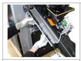
$\hfill\Box$  Abdeckung des Kabelkanals abnehmen
