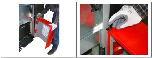
☐ Isoliertür beim Kesselboden einhängen und mit Arretierbolzen sichern
