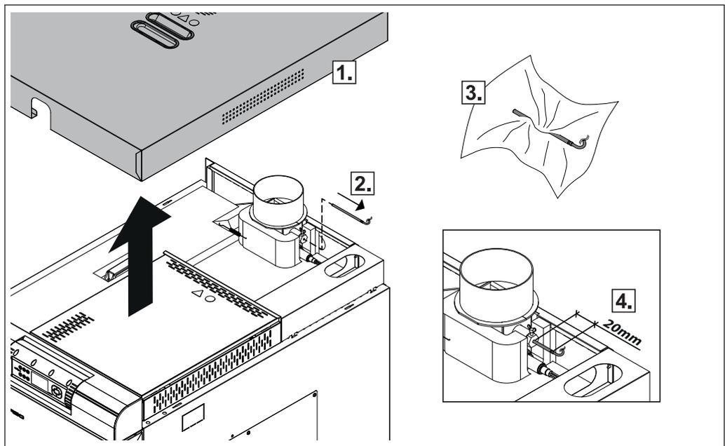
1. Déposer le couvercle isolant
