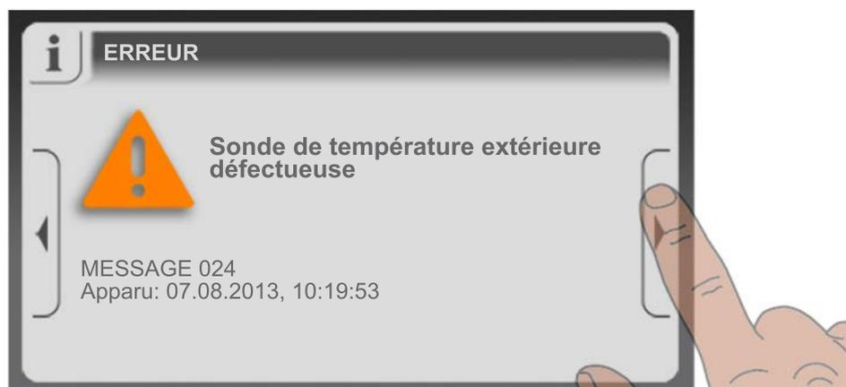
Si la fenêtre comportant le texte d'erreur correspondant s'ouvre, appuyer sur la flèche vers la droite pour consulter les causes possibles du défaut.
