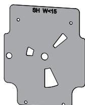
Pour la combustion optimale de combustibles contenant moins de 15 % d'eau, l'arrivée d'air doit être ajustée. Pour cela, les sections d'arrivée d'air sont optimisées au moyen d'une tôle de réduction du débit d'air (réf. Fröling T244132). Les étapes suivantes illustrent le montage.
