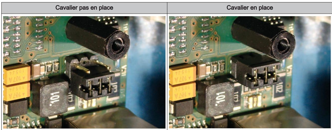
Si les contacts au niveau du socle du cavalier d'extrémité ne sont pas pontés (figure de gauche), le cavalier n'est « pas en place ». Dans ce cas, la liaison du bus n'est pas établie. Si les contacts sont fermés (figure de droite), le cavalier d'extrémité est en place et la liaison du bus est établie.
