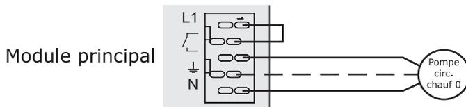
**Branchement d'une pompe de circuit de chauffage 0 de 5 ampères maximum :**
