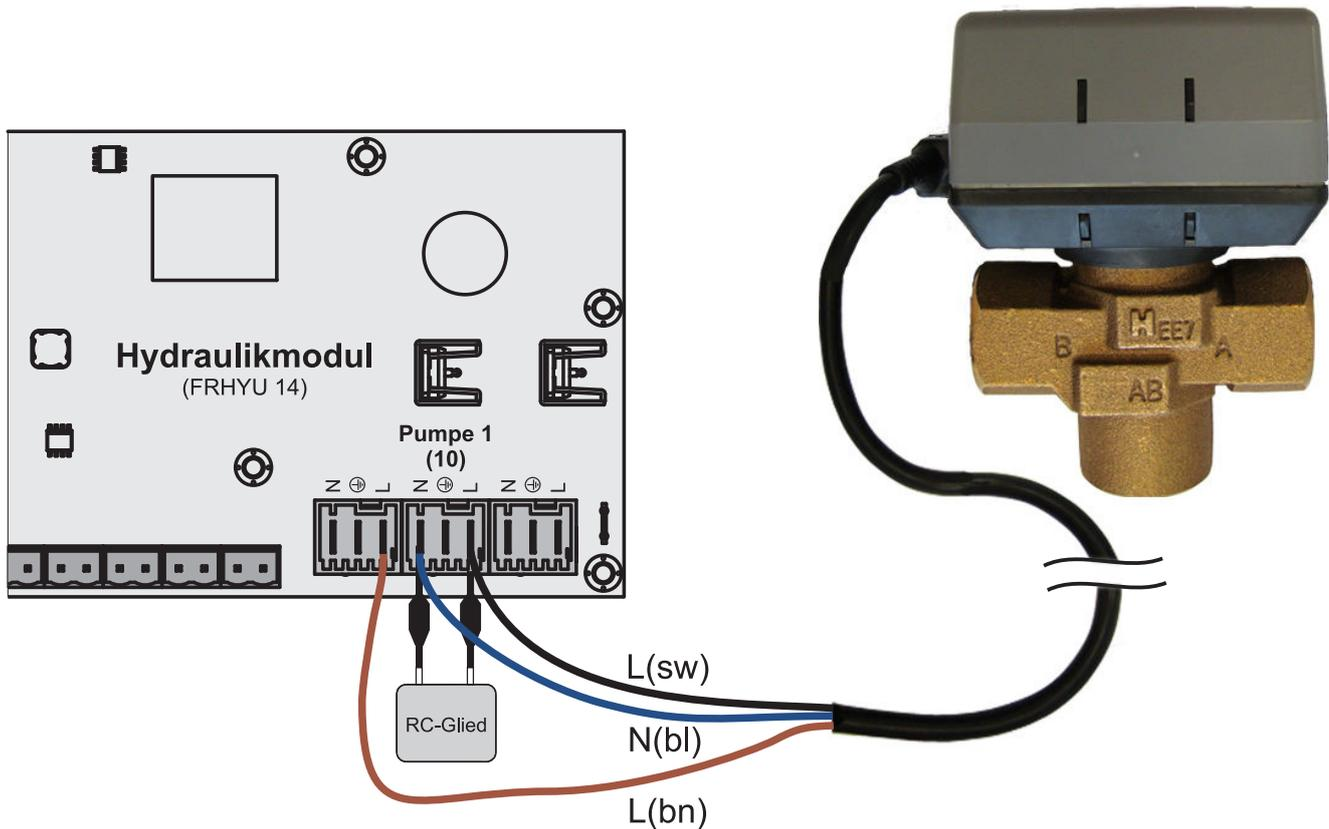
Le conducteur extérieur L(bn) peut être branché au conducteur extérieur de l'alimentation secteur du module ou au module principal, la sortie HKP0/relais du brûleur à la broche « LV ».
