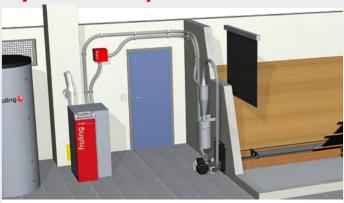
Le système d'extraction à vis sans fin et aspiration Froling est la solution idéale pour les locaux rectangulaires avec prélèvement frontal.
