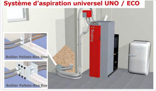
Le système d'aspiration est adapté aux grandes distances entre le silo et la chaufferie. La position des sondes d'aspiration ou de l'unité de transfert peut être adaptée à chaque silo. Le passage d'une sonde d'aspiration à l'autre s'effectue manuellement (boîtier pour granulés Eco). Il existe une version du système d'aspiration universel spécialement conçue pour les locaux carrés, également avec une seule sonde (boîtier pour granulés Uno).
