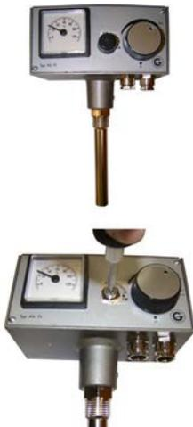
Der Sicherheitstemperaturbegrenzer (STB) schaltet den Kessel bei einer Temperatur von ca. 100 °C ab. Sobald die Temperatur unter ca. 75°C gesunken ist, kann der STB mechanisch entriegelt werden:
