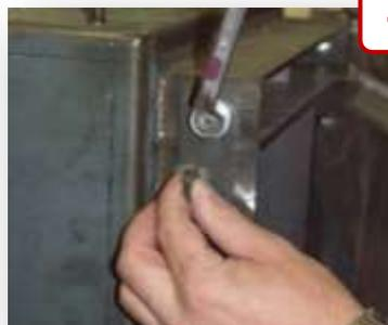
1. Desserrer l'écrou de sécurité (S) des excentriques de serrage.
