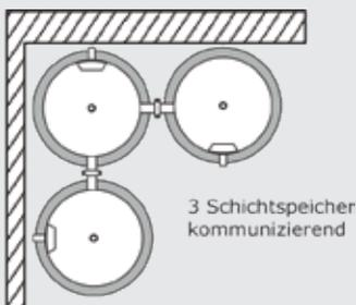
Zusätzlich zur Aufstellung in einer Reihe gibt es die Möglichkeit die Schichtspeicher über Eck aufzustellen. In diesem Fall sind beim mittig situierten Schichtspeicher die Verbindungskupplungen um 90° versetzt angebracht.
