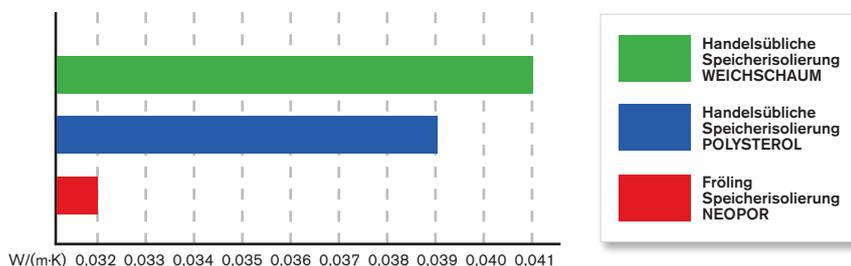
Neopor® ist die Weiterentwicklung des Dämmstoffes Styropor®. Dabei wird das Schaumpolyester mit Graphitteilchen angereichert, welche die Wärmestrahlung streuen und so den Wärmeverlust reduzieren.
