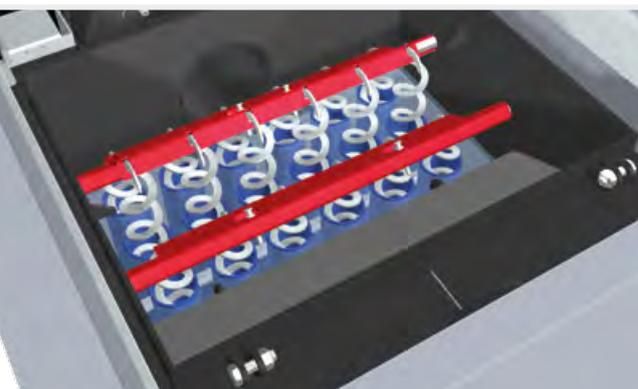
Das Wirkungsgrad-Optimierungs-System WOS besteht aus speziellen Wirbulatoren, die in den Wärmetauscherrohren eingesetzt sind, und ermöglicht eine automatische Reinigung der Heizflächen. Saubere Heizflächen gewährleisten einen hohen Wirkungsgrad und somit eine Brennstoffersparnis.
