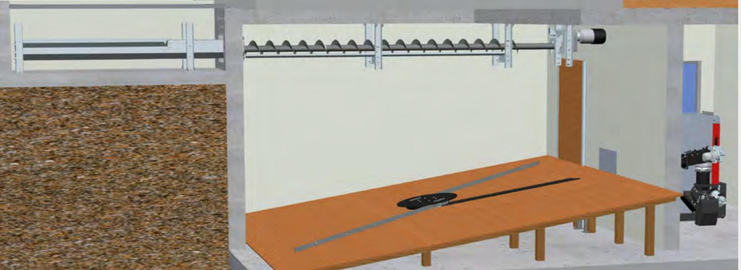
Durch die außerhalb des Lagerraums positionierte Schüttgasse wird der Brennstoff über die Bunkerbefüllschnecke in den Lagerraum transportiert. Die Bunkerbefüllschnecke stoppt automatisch, wenn der Lagerraum voll ist. Der dargestellte Schrägboden im Lagerraum ist für die einwandfreie Funktion der Austragung nicht erforderlich.
