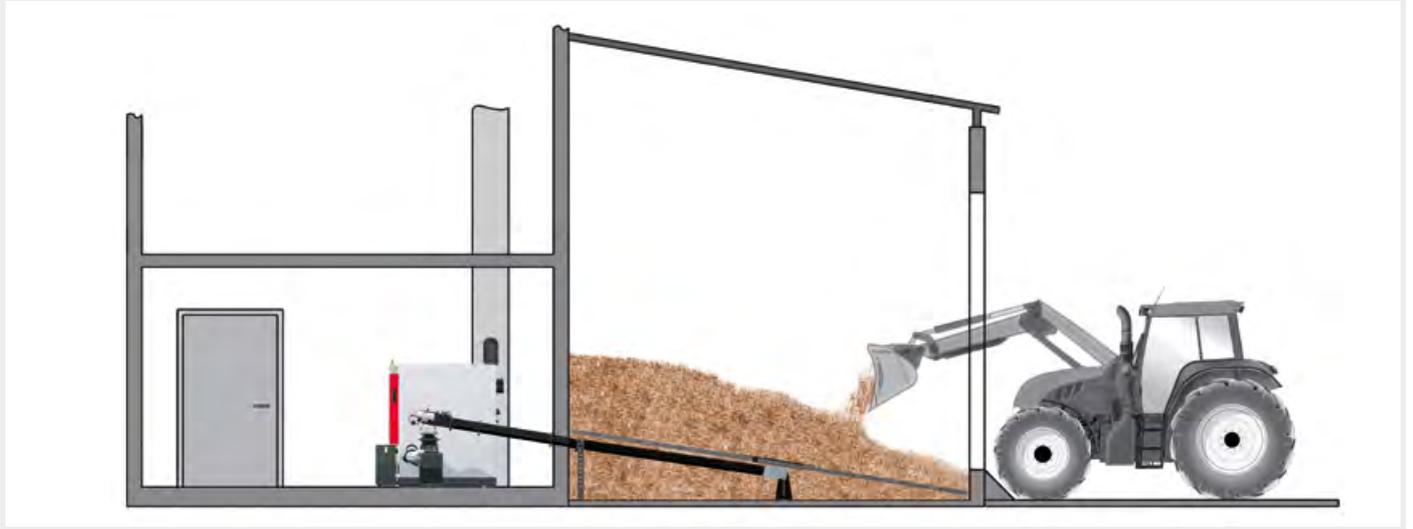
**Einbringung mit Bunker-Befüllschnecke**
