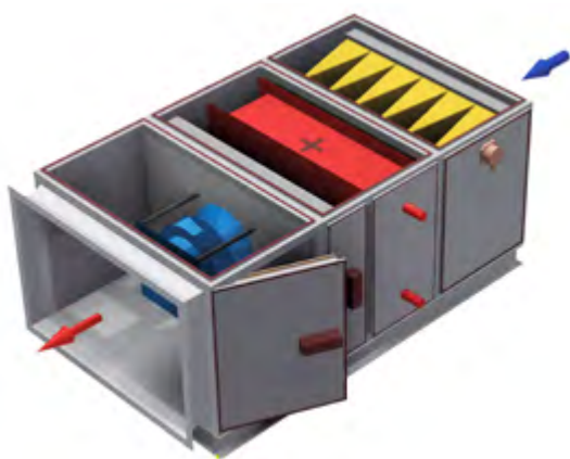
Liegende Kirchenheizung mit EC-Ventilator als Freiläufer
