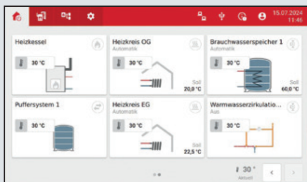
Overzicht van de geïnstalleerde installaties in tegelweergave
