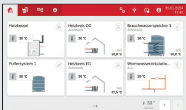
Overzicht van de geïnstalleerde installaties in tegelweergave
