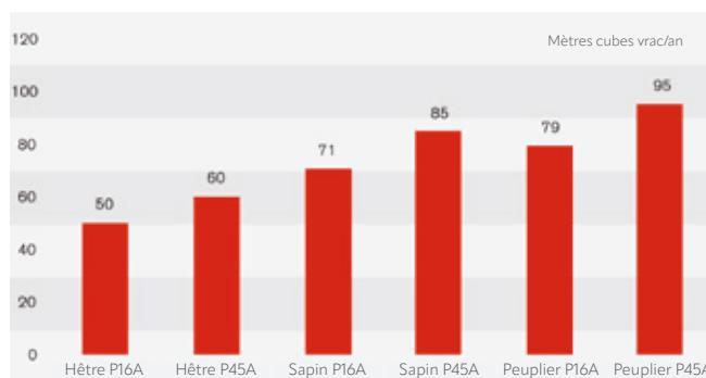
Exemple de consommation annuelle d'environ 57 500 kWh (T4e 30 kW, 1 600 heures à pleine charge, rendement de 93,5 %, bois déchiqueté M30 anciennement W30).
