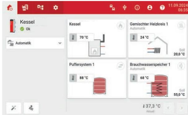
Auf der ersten Seite des Grundbildes wird eine Übersicht der Wärmequelle und das Dashboard abgebildet. Alle sichtbaren Komponenten und deren wichtigste Werte werden hier aufgelistet. Die Darstellung und Position der Komponenten kann individuell angepasst werden. Es sind mehrere Seiten möglich, zwischen denen mit Wischgeste oder Pfeil-Symbol gewechselt werden kann. Die Betriebsart der Wärmequelle kann eingestellt und durch Tippen auf die Kacheln die jeweilige Komponentenübersicht geöffnet werden.
