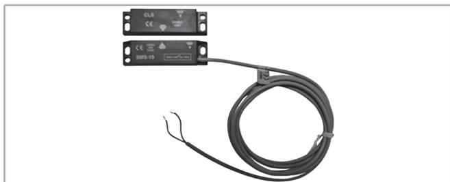
Au moment de l'ouverture des portes, le contact de porte DSC, active le fonctionnement du rideau d'air (ventilation, ouverture vanne, alimentation résistances internes) et l'arrête lorsque les portes sont fermées.
