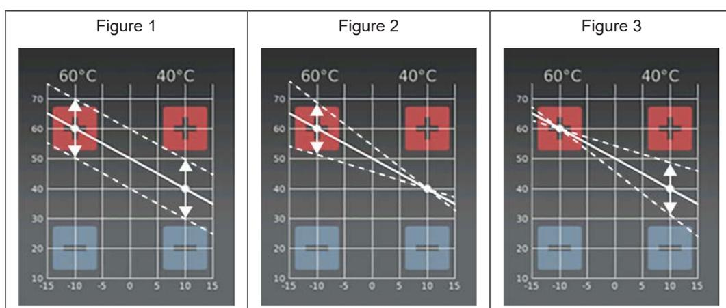
La courbe de chauffage peut être ajustée en fonction de la situation en appuyant sur « + » ou « - » à une température extérieure de +/-10 °C.
